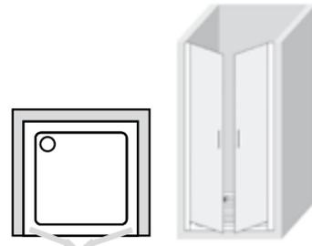
Si la mampara Plutón 2P, se instala con un lateral Fijo en ángulo, la Puerta que articula contra el lateral Fijo, sólo abrirá hacia el exterior.
