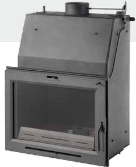
El hogar calefactor H-03/70, con paila de acero y frente de hierro fundido, ofrece una potencia total de 23 Kw (12,4 Kw de potencia cedida al agua y 9,6 Kw de potencia cedida al ambiente). Para mayor seguridad en el funcionamiento, el hogar H-03/70 Calefactor incorpora de serie un serpentín de cobre que refrigera el cuerpo de la paila en caso de sobrecalentamiento.
