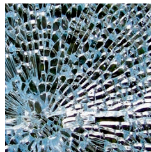
Rotura de Vidrio Templado
