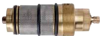
Nuestros termostatos cumplen con los requisitos de sensibilidad, estabilidad y seguridad exigidos en la Norma EN 1111. Hemos perfeccionado su funcionamiento con elementos como válvulas antirretorno protegidas por filtros de fácil acceso y una válvula corredera de diseño antiadherente. La función antiquemaduras del botón limitador de temperatura a 38°C, viene reforzada por el diseño del mezclador, que hace circular el agua caliente por la parte posterior del termostato evitando
