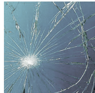
Rotura de Vidrio Sin Templar
