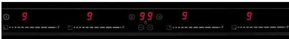
Con sólo deslizar un dedo a través de su línea recta, incrementarás el nivel de potencia de cada zona de cocción. Su nivel de potencia aparecerá en cada display, al igual que el tiempo programado necesario para cada receta.
