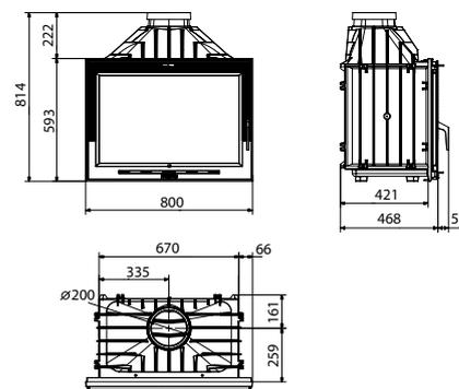
Cámara de combustión en fundición | Doble combustión
