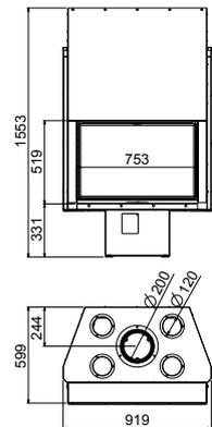
Puerta de guillotina con apertura batiente | Interior en fundición y cerámico refractario | Carenado de convección
