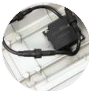
Controlador de carga con incorporación de modo ahorro
