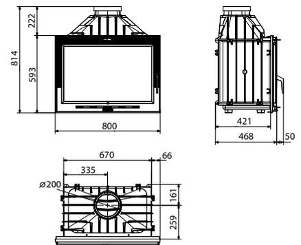
Cámara de combustión en fundición | Doble combustión
