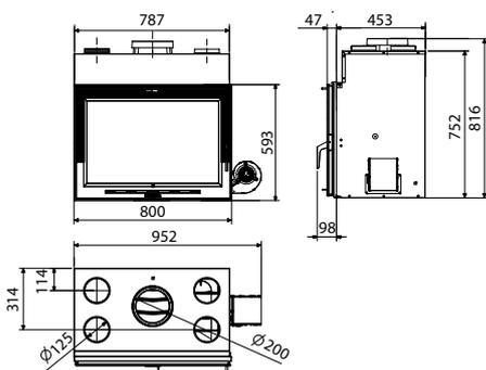
Cámara de combustión en fundición | Doble combustión | Canalización con turbina | Mando a distancia
