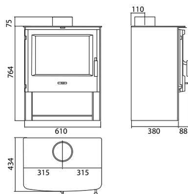
Estructura en acero | Puerta en hierro fundido | Doble combustión
