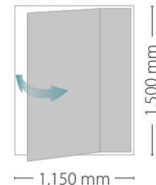
Este producto se podrá modificar las medidas de fijo y hoja a petición del cliente no excediendo el ancho total de 1.150 mm (medida máxima hoja 850 mm y medida mínimo del fijo 200 mm)
